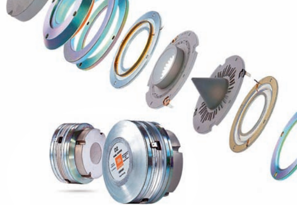
Den komplexa diskanten vars dubbla ringmembran (nr 2 och 5 från höger) både förhindrar konuppbyggnad, ökar omfånget och minskar värmekompressionen.
